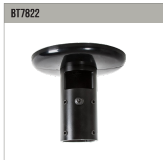
Mocowanie sufitowe/podłogowe dla wysięgników o średnicy 50mm, max. obciążenie 150kg
